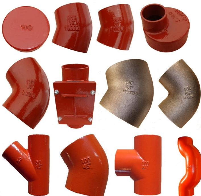
**Трубы sml** – это качественные конструкции, выполненные из литейного чугуна. СМЛ трубы изготавливают путем центробежного литья. Такие изделия соответствуют основным требованиям, которые установлены в области современного строительства. Продукция отличается отсутствием привычных раструбов. Благодаря этому трубы соединяют между собой «стык в стык» при помощи хомутов. Они состоят из манжет, которые выполнены из стали и высококачественной резины EPDM.
