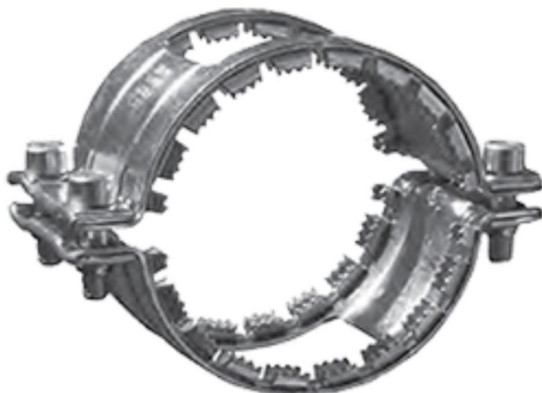
Kombi-Kralle – обжимная манжета кралле для защиты межтрубного соединения от продольного смещения с высокой растягивающей нагрузкой.
